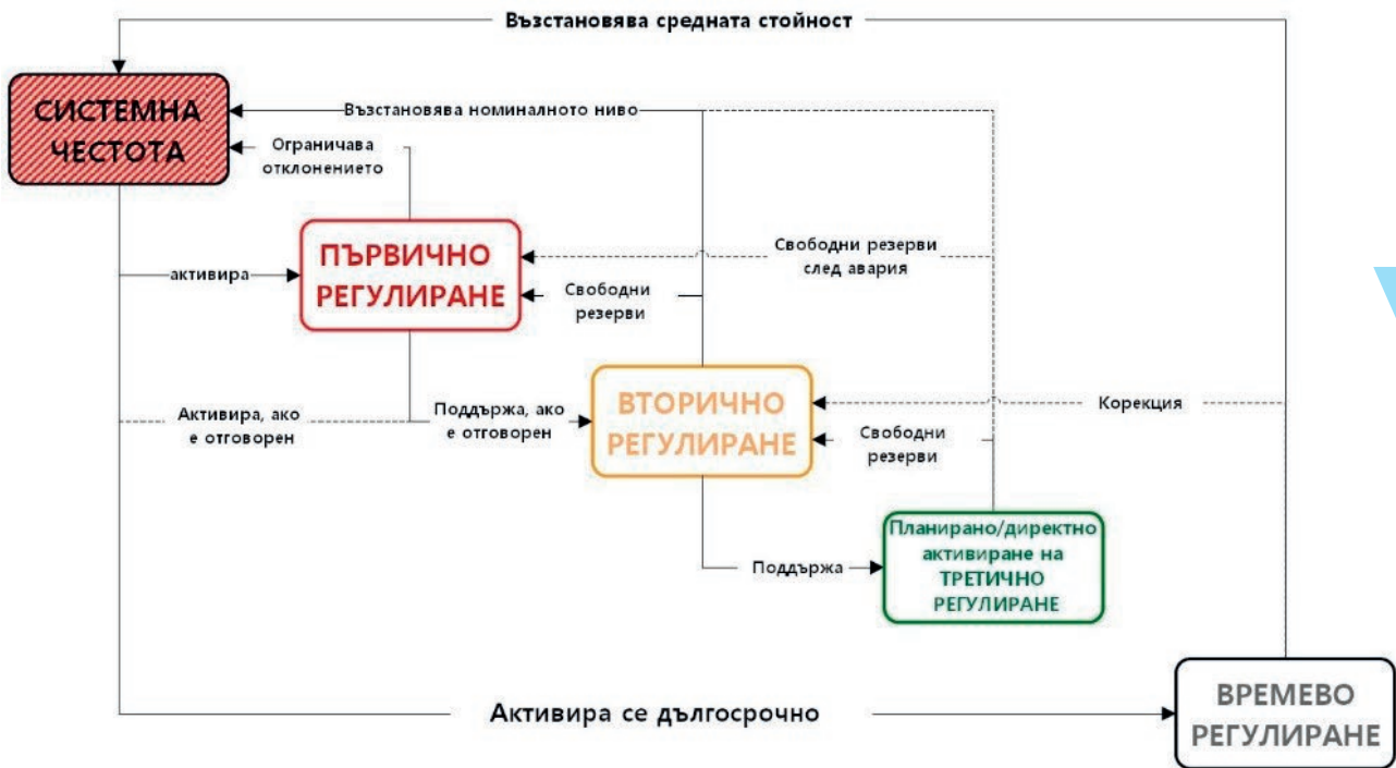
Фиг. 1. Схемa за регулиране и действия при отклонение на системната честота
