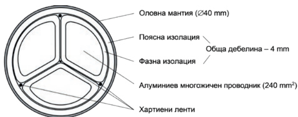
Фиг. 7. Конструкция на 12 kV хартиено-маслен кабел
